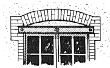
linteau métallique, sous un arc de décharge en brique
